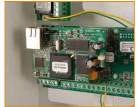
Particolare della centrale SmartLiving10100 con la scheda SmartLAN/G.
